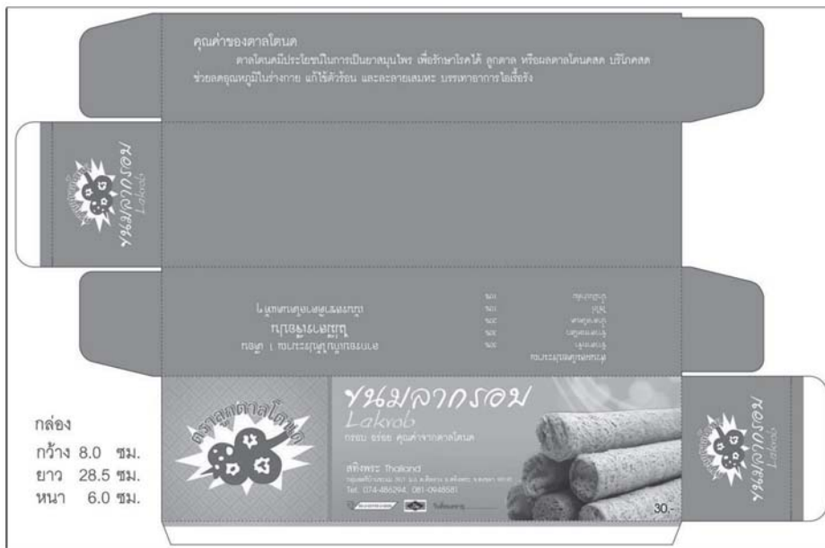
ภาพที่ 3 บรรจุภัณฑ์ขนมลากรอบแบบใหม่ ขนาดความกว้าง 8 ซม. ความยาว 28.5 ซม. ความหนา 6 ซม.
