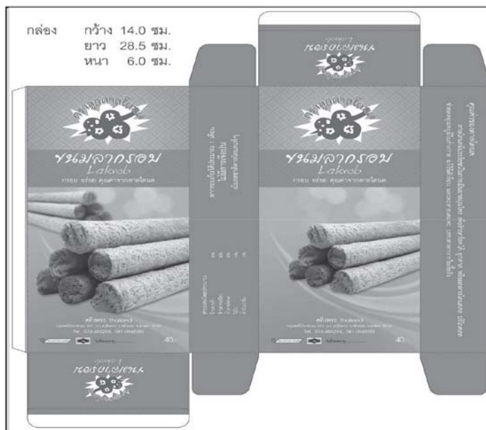
ภาพที่ 2 บรรจุภัณฑ์ขนมลากรอบแบบใหม่ ขนาดความกว้าง 14 ซม. ความยาว 28.5 ซม. ความหนา 6 ซม.
